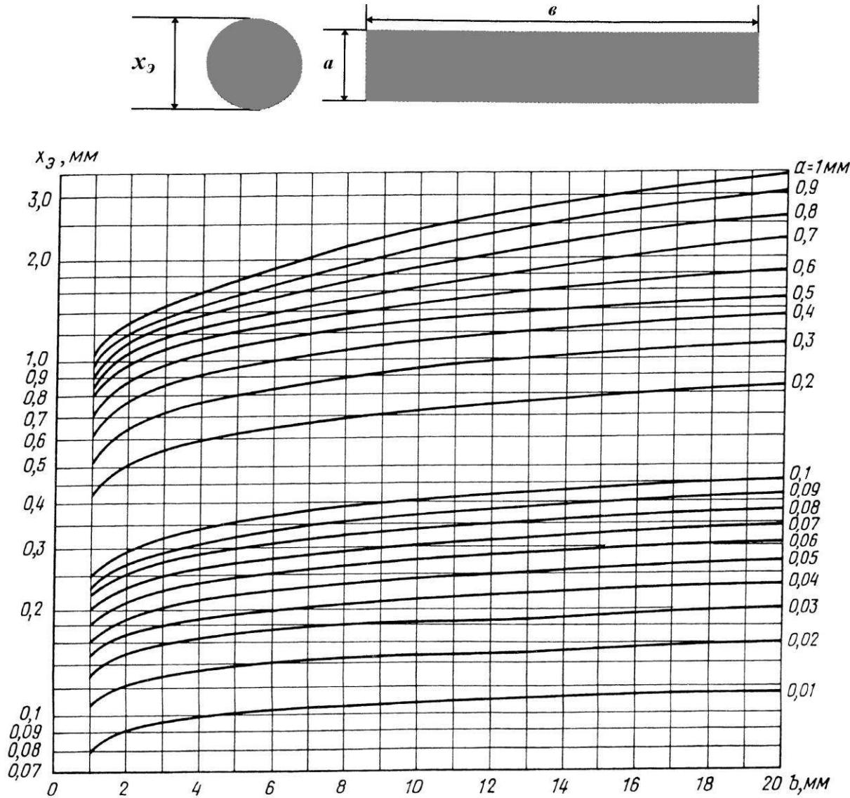
Рис. Г.1. Номограмма для определения эквивалентного размера протяженных объектов различения при расстояниях от глаза до объекта до 500 мм.
